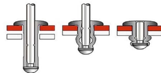
Надежность и долговечность соединений при монтаже строительных конструкций различного назначения достигается за счет применения специализированной фурнитуры. Одними из наиболее прогрессивных крепежных элементов на сегодняшний день являются строительные заклепки.
